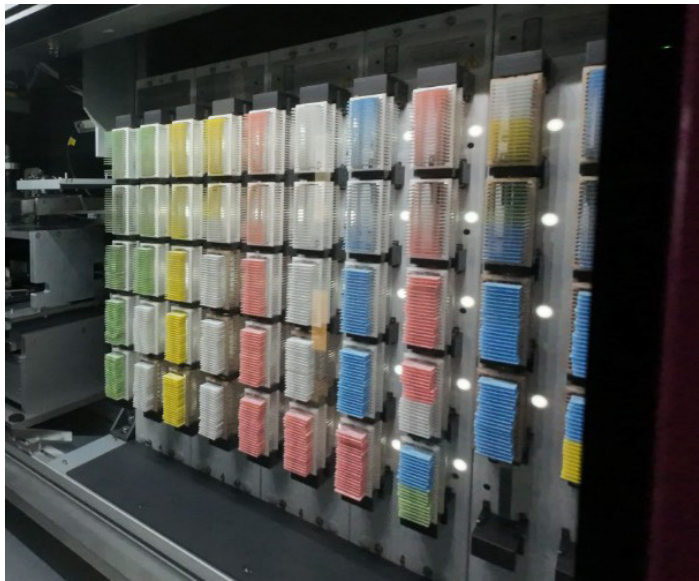
Bild 3: Gedruckte Objektträger, die in Objektträger-Körbe übertragen und in den E1000 Dx geladen wurden.
